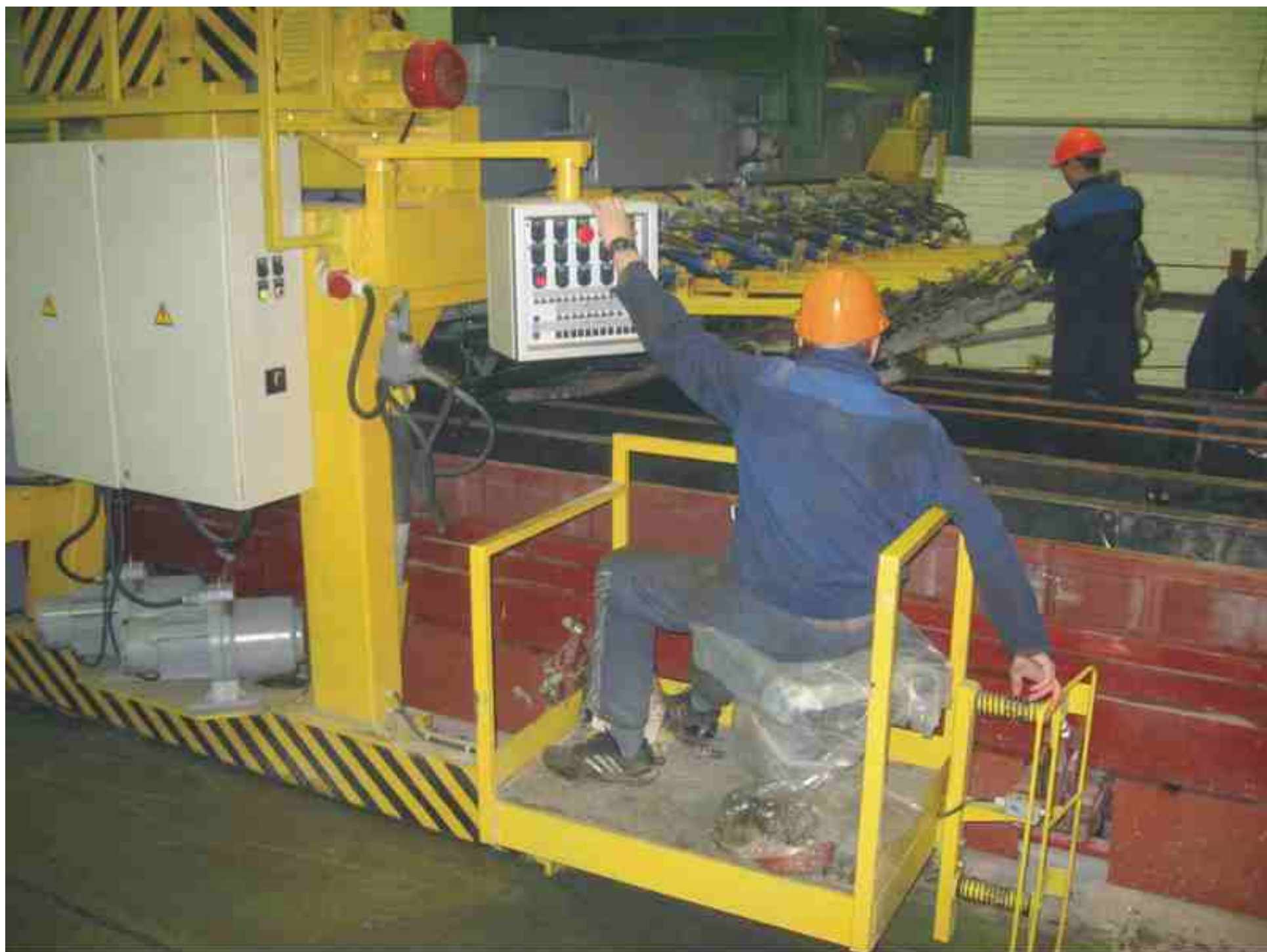
Автоматизированное управление подачей бетона и уплотнение бетонной смеси в ручьях универсального стенда, г. Миасс 2007 г.
