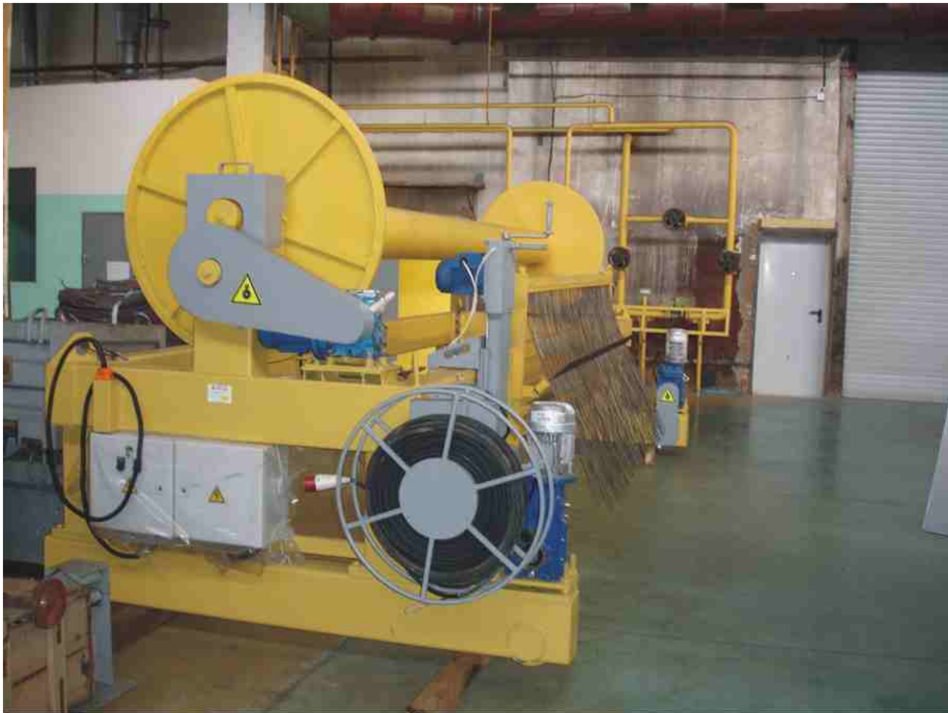
Размотчик термопокрывала с бороздобразователем на одной самоходной раме для универсального стенда. 2008 г. ЗАО "Рекон"
