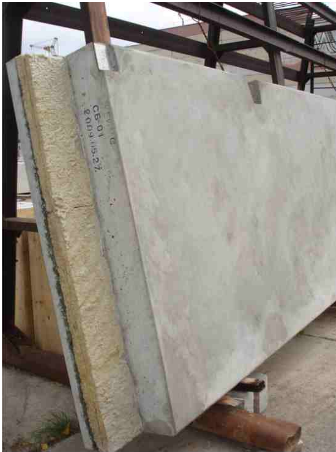
Трехслойная стеновая панель 1.8 x 6.0 (м) выполненная на универсальном стенде. ЗАО "Рекон" г. Чебоксары, 2009. ОАО "Монлитстрой"
