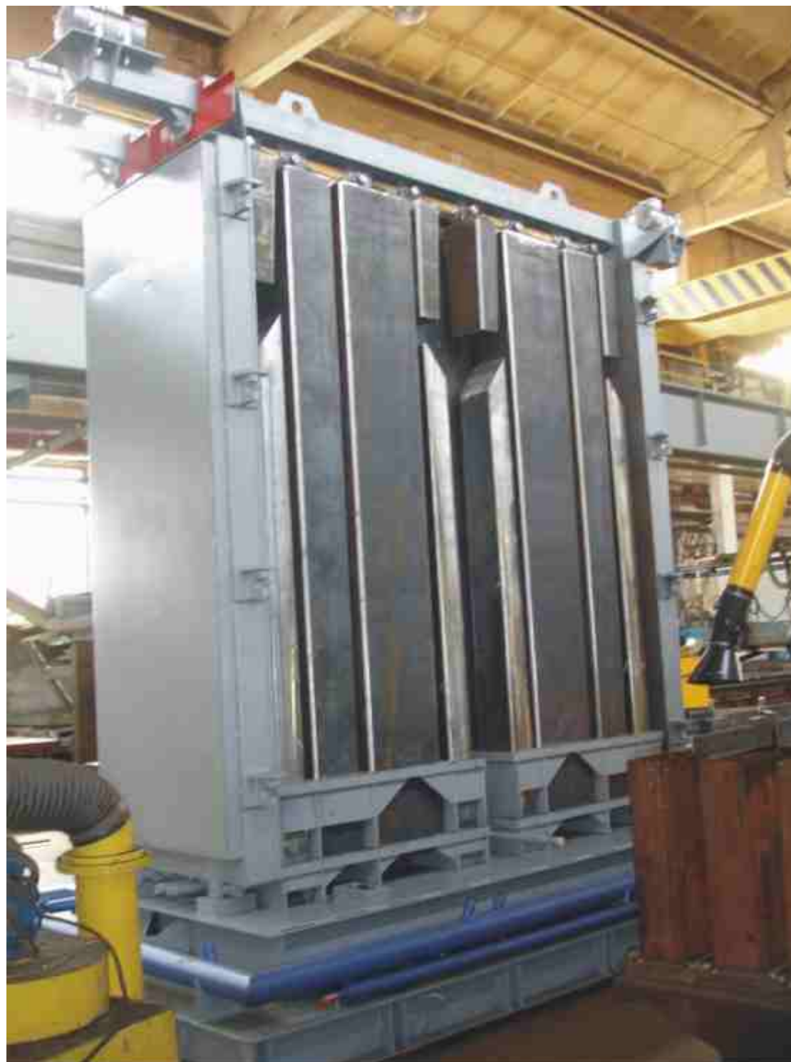
4-х секционная автоматизированная установка по выпуску вентблоков. ЗАО "Реком", 2008, Чебоксары.
