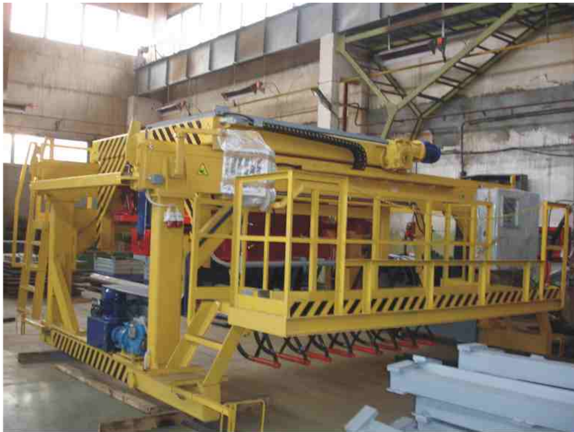
Универсальный вибробетонукладчик с подвижным бункером и механизмом перемешивания и выдачи бетона на универсальном стенде. 2008 г. ЗАО "Рекон"
