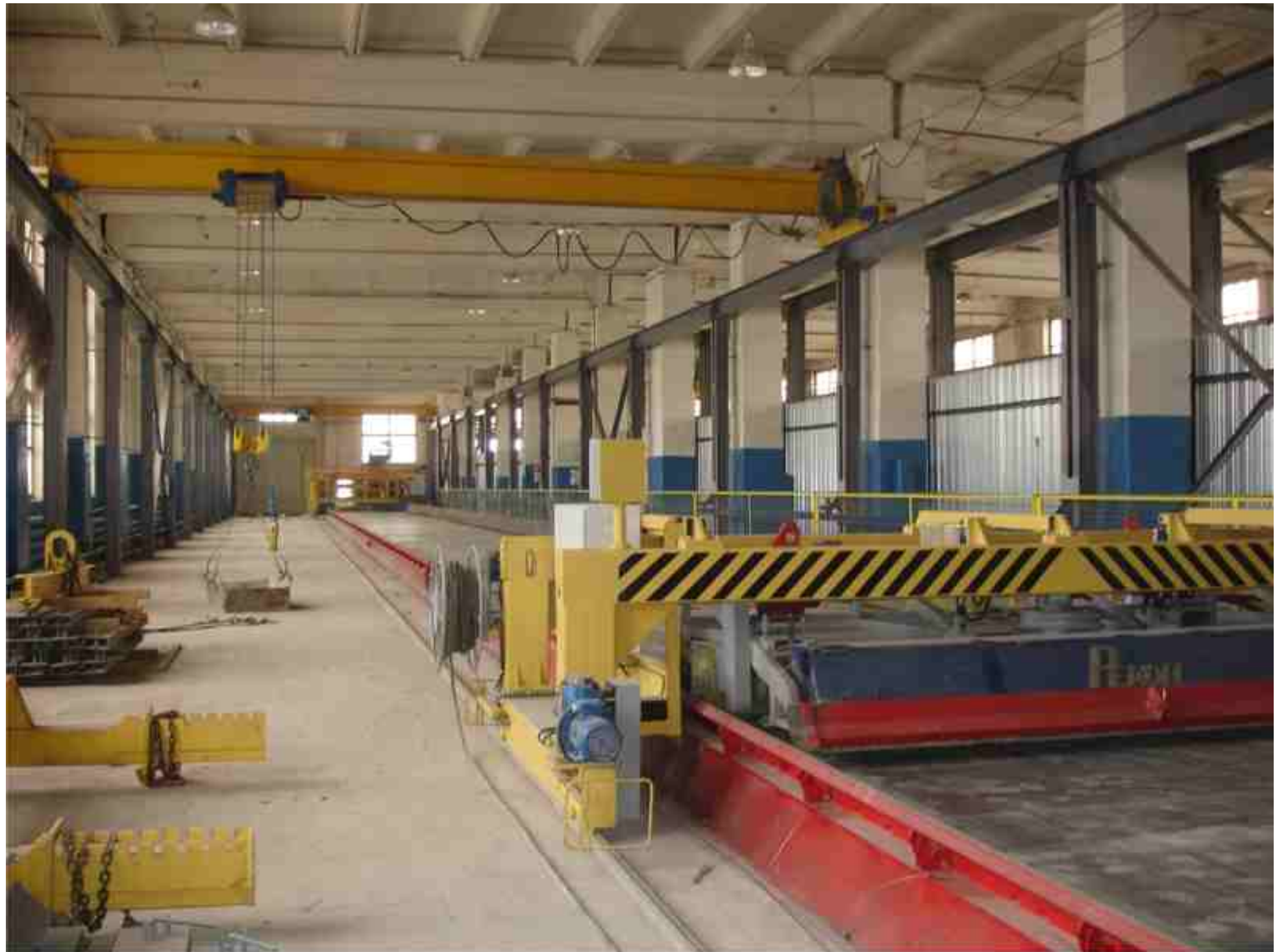
Универсальный стенд по выпуску "НС", плит-несъемная опалубка, колонн, диафрагм жесткости. Май 2009 г., ЖБИ-1, ЗАО "Рекон", Чебоксары
