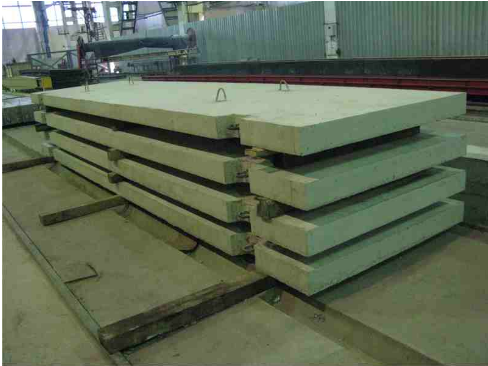
Изготовление конструкций наружных стен с вентилируемым фасадом для строительства школ и садиков на универсальном стенде в ООО "Рекон-Ижора".04.03.09, С.-Петербург
