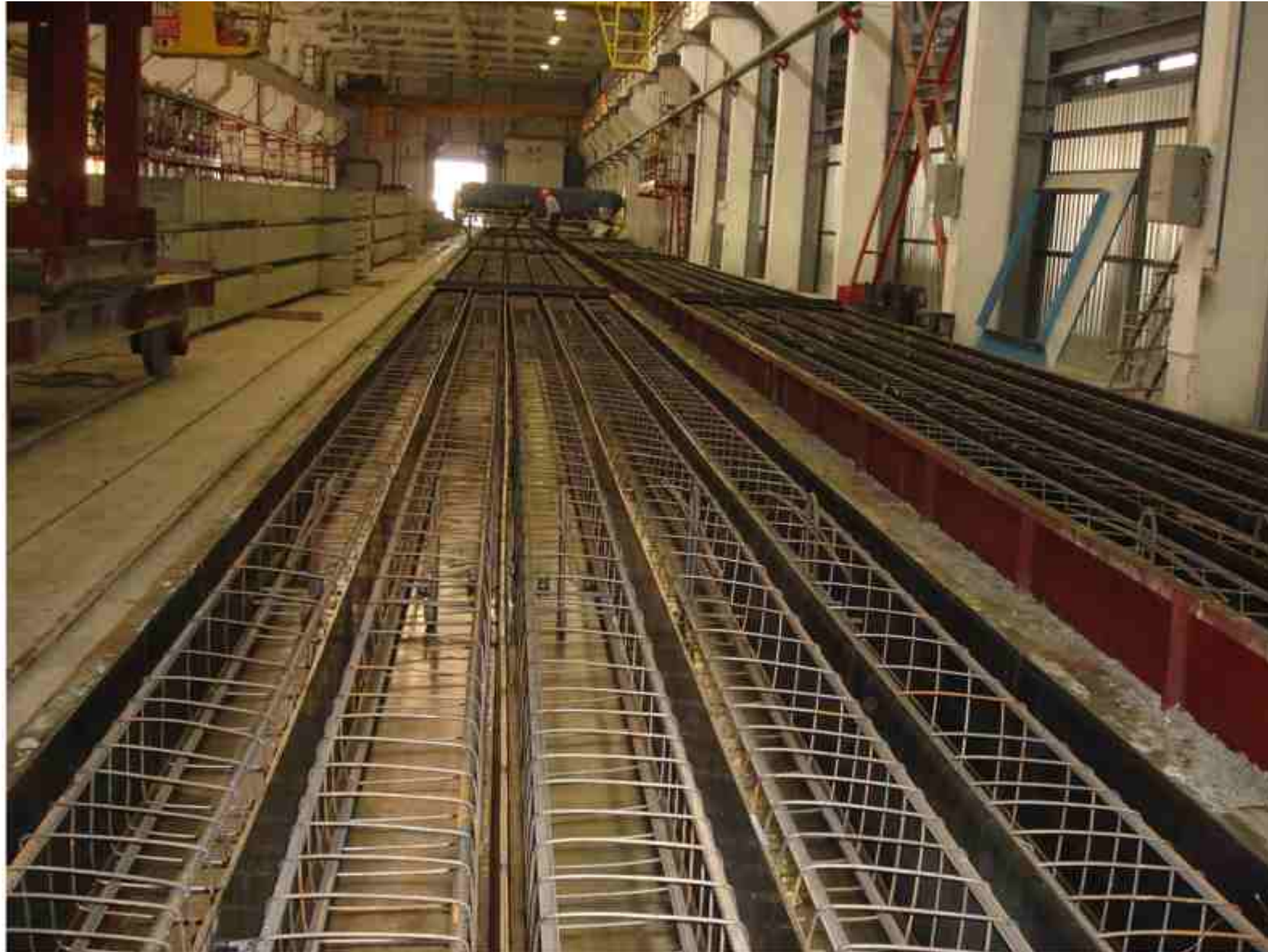
Универсальный стан 4.0 x 90.0 оснащенный под выпуск 1.200 п/м свай преднапряженных и непряженных в сутки Сентябрь 2009 г. Челябинск. Группа компаний "ДЭФА"
